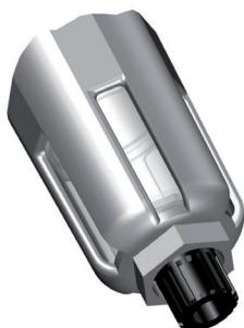
Per lo smontaggio della tazza utilizzare una chiave esagonale a tubo. Le aperture trasparenti sulla tazza permettono il controllo del livello della condensa per il filtro o dell'olio per il lubrificatore.
