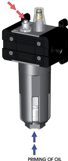
**Il caricamento dell'olio a depressione** consente il riempimento in automatico di olio nella tazza. Il sistema si attiva mediante l'azionamento di un pulsante e l'olio prelevato da un serbatoio posto anche a quote più basse rispetto al lubrificatore fluisce nella tazza grazie ad un attacco G1/4 posto sotto di essa. Il caricamento deve essere interrotto quando l'olio raggiunge il livello massimo consentito corrispondente alle aperture trasparenti della tazza.
