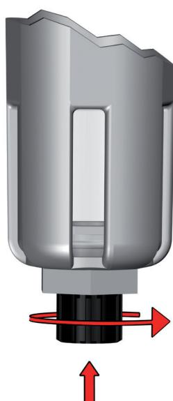
Lo scarico della condensa Manuale / Semiautomatico è normalmente nella posizione aperta cioè scarica automaticamente la condensa quando è assente la pressione nella tazza, premendo la manopola è possibile scaricare la condensa in presenza di pressione, ruotando la manopola in senso antiorario lo scarico è nella posizione chiusa.
