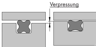
Bei statischer Anwendung sollte die mittlere Verpressung bezogen auf die Schnurstärke 10 – 25%, bei dynamischer Anwendung 8 – 20% betragen.
