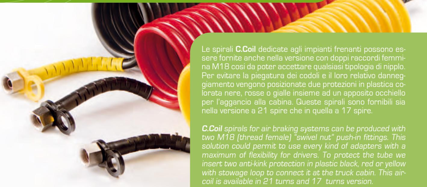
Le spirali **C.Coil** dedicate agli impianti frenanti possono essere fornite anche nella versione con doppi raccordi femmina M18 così da poter accettare qualsiasi tipologia di nipplo. Per evitare la piegatura dei codoli e il loro relativo danneggiamento vengono posizionate due protezioni in plastica colorata nera, rosse o gialle insieme ad un apposito occhiello per l'aggancio alla cabina. Queste spirali sono fornibili sia nella versione a 21 spire che in quella a 17 spire.
