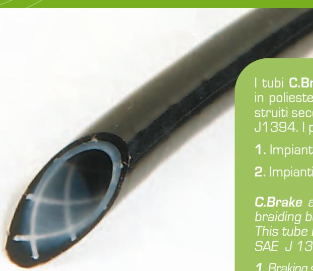
I tubi **C.Brake** sono tubi multistrato rinforzati con treccia in poliestere tra i due strati di PA11. Questi tubi sono costruiti secondo la normativa SAE J844 tipo B ed anche SAE J1394. I principali campi di utilizzo sono:
